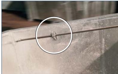
Zur leichten Befüllung können alle Behälter mit einem Deckelhalter ausgerüstet werden; nach Befüllen wird die Haltestange wieder im Inneren des Behälters eingeclipst.
