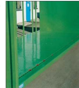
Heckklappe befahrbar und pendelbar
