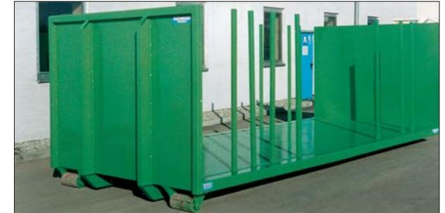
Detail „Endlossteckmöglichkeit“, vor allem zum Transport von Großflächenschalung geeignet
