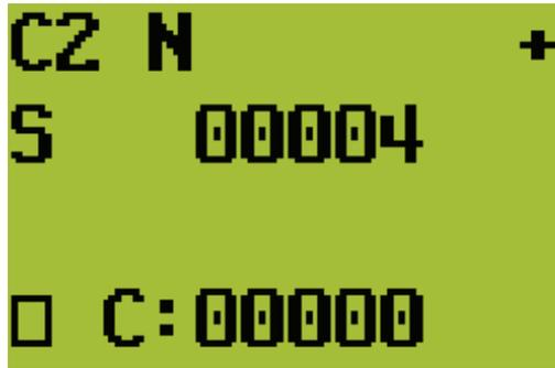
Es blinkt ein Cursor zum Verändern der Parameter. Wählen Sie mit den Pfeiltasten den Parameter "S" und drücken Sie auf "OK". Verändern Sie mit den Pfeiltasten den Parameter "S". Bestätigen Sie Ihre Eingabe mit "OK". Um den Vorgang abubrechen drücken Sie die "ESC" Taste.
