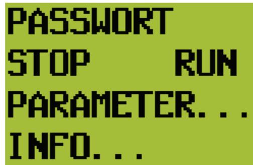
Drücken Sie die Pfeiltasten hoch oder runter bis "Parameter..." blinkt. Bestätigen Sie die Auswahl mit "OK"
